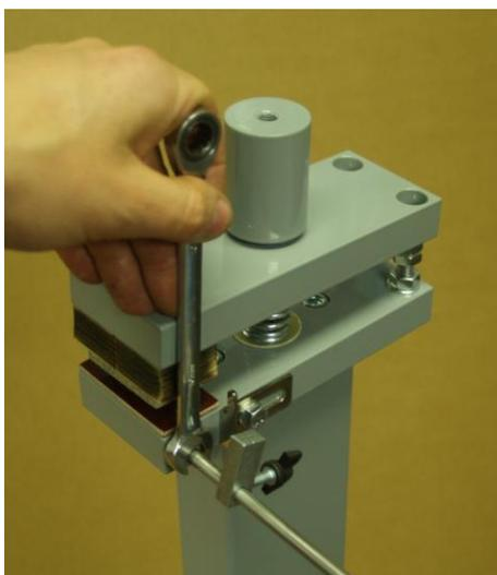
Установите боковую направляющую, как показано на рисунке. Используйте гаечный ключ М10 (в комплект не входит) для фиксации. Боковая направляющая может быть установлена с любой стороны аппарата.
