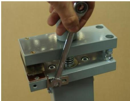
Установите задние направляющие и зафиксируйте их болтами М6х10, как показано на рисунке. Используйте гаечный ключ М10 (в комплект не входит) для фиксации.
