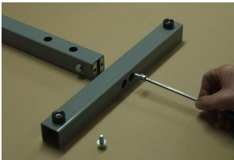
2. Присоедините верхнюю часть рамы с помощью винтов M8 как показано на рисунке. Используйте 6-тигранный ключ 6мм (в комплект не входит) для фиксации винтов.
