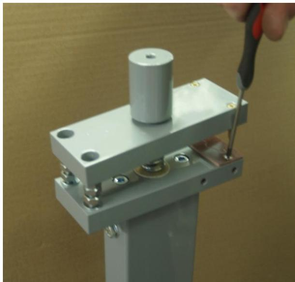
Марзан VMP-1 прикреплен двумя винтами к внутренней ответной части вырубщика. Для замены выкрутите винты и переверните на другую сторону, далее зафиксируйте винтами. После прорезания марзана с обеих сторон используйте новый марзан.
