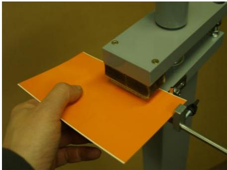
Установите направляющие в требуемое положение для осуществления пробивки в нужном месте. При нажатии на педаль Вы получите отверстие установленной формы. Для сложных либо нестандартных форм используйте специальные направляющие.
