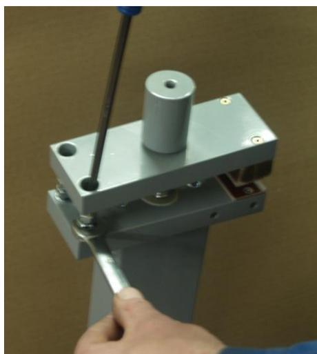
Ослабьте винты М8 на обратной стороне аппарата, как показано на рисунке, отрегулируйте параллельность до получения правильной вырубki, затем затяните винты.
