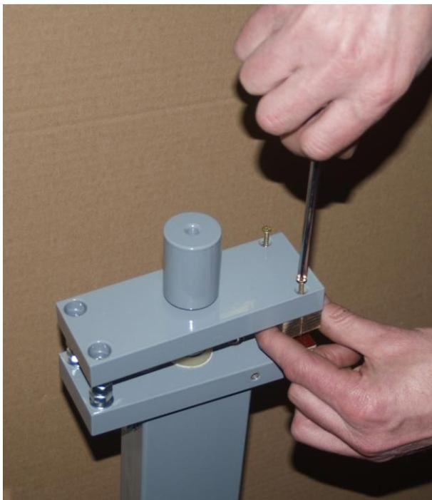
Для замены тула выкрутите два фиксирующих винта, как показано на рисунке. Поставьте новый тул и закрепите винтами.
